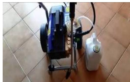
ASPIRAZIONE DEL DETERGENTE DIRETTAMENTE CON LA IDROPULITRICE.
