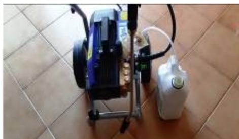
ASPIRAZIONE DEL DETERGENTE/SANIFICANTE DIRETTAMENTE ASPIRATO CON LA IDROPULITRICE E DISTRIBUITO CON LA LANCIA
