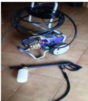
DISTRIBUZIONE DELLA SCHIUMA MEDIANTE LANCIA SCHIUMA. CONTENITORE APPLICATO ALLA PISTOLA DELLA IDROPULITRICE.
