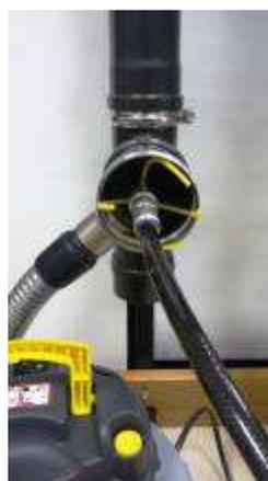
Con la sonda ROTO CLEANING STUFE collegata ad un trapano di circa 600/800 W, è possibile pulire (fresare) in pochi minuti una canna fumaria di dimensioni da 80 a 200 mm, fino alla lunghezza max di 10/15 mt. ROTO CLEANING STUFE supera facilmente curve e gomiti a 90°, è dotata di spazzola espandibile, che si adatta a qualsiasi forma della canna fumaria. La pulizia avviene in sicurezza per l'operatore poiché la rotazione del cavetto è protetto da una guaina esterna.
