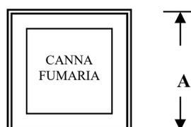
**STRUTTURA** Lamiera acciaio decapato spessore 2 mm – Lavorazione laser – Verniciatura anticorrosione Robotizzata per cataforesi colore RAL 8016 (ruggine)
